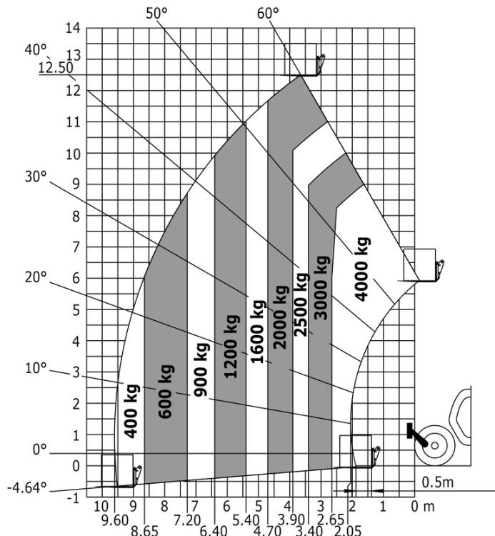
Máquina sobre estabilizadores rebaixados com garfos Metric
